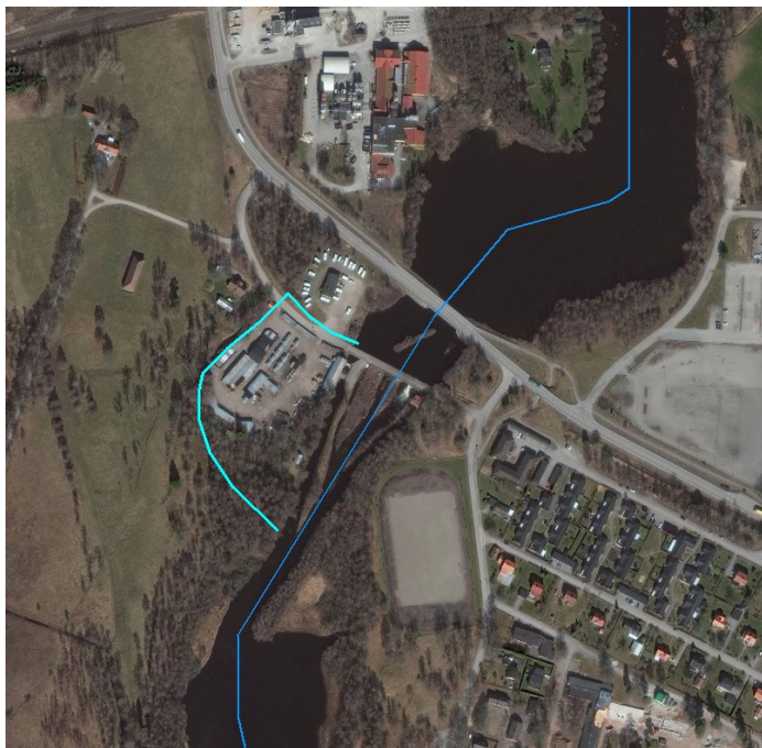
Figur 1. Räppe damm med ny förbiledningskanal väster om dammen.
