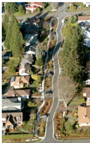
T.v: Ett djupt biodike med varierad vegetation. High Point, Seattle. Bild: Giraldo och Leighton (2007). T.h: En av gatorna som smalnats av och givits en slingrande form för att minska andelen hårdjord yta och uppmuntra bilisterna att sakta ner. Biodiket som sträcker sig längs med vägen får därmed en svagt meandrande form. Foto: CRD (2009-05-07).
