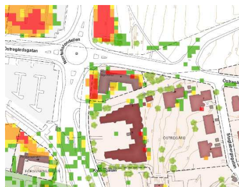
Karta över översvämningsrisken vid ett 100 års regn i planområdet där röd innebär störst översvämningsrisk.
